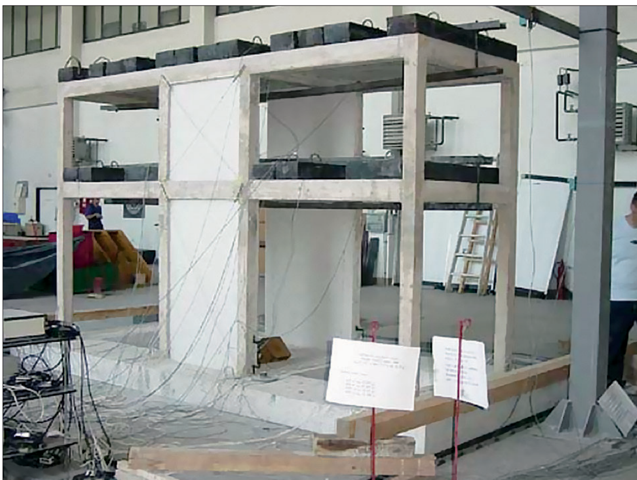
Slika 1. Stresalni preskus na maketi večnadstropne konstrukcije v laboratoriju IZIIS, Skopje Figure 1. Demonstration of seismic shaking table test on a multi-storey frame at IZIIS Dynamic Testing Laboratory, Skopje.
