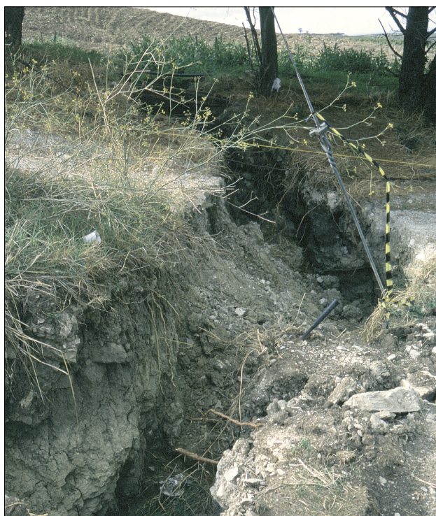
Slika 9. Nastale so razpoke, dolge 3 km, globoke več metrov in široke do 1 m. Na sliki vidimo prečno razpoko na plaz (foto: R. Vidrih).
