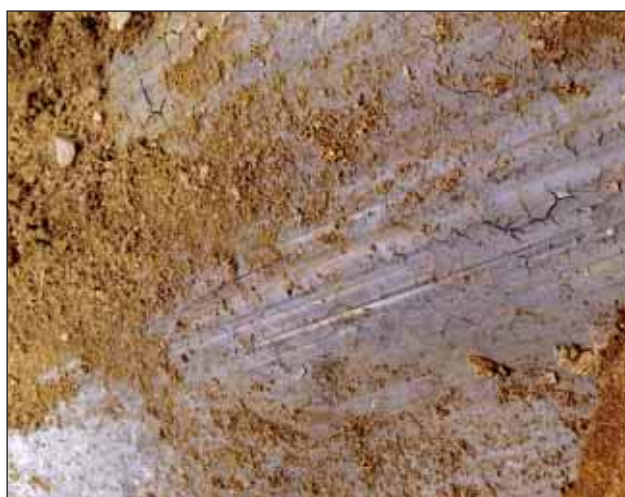
Slika 5. Gibanje zemljine v zemeljskem plazov (5a). Rjava zemljina, glinasti melj s peskom drsi po mastni glini. Posnetek iz vkopa na AC Arja vas-Vransko. Na sliki 5b je bližnji posnetek drsne ploskve. V prikazanem primeru je rekonstrukcija plazov in določitev materialnih parametrov zemljin v kritičnem območju enostavna. Pri večini plazov pa so v drsni ploskvi zemljine premešane, pregnetene in zelo heterogene, zato je preiskovanje in določanje strižnih parametrov pogosto zelo težavno. (foto: A. Petkovšek)
