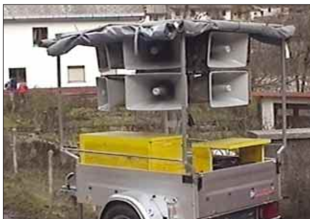
Slika 4. Mobilna radijsko krmiljena sirena Figure 4. Mobile radio-controlled siren
