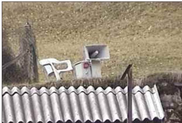
Slika 3. Prenosna radijsko krmiljena sirena Figure 3. Portable radio-controlled siren
