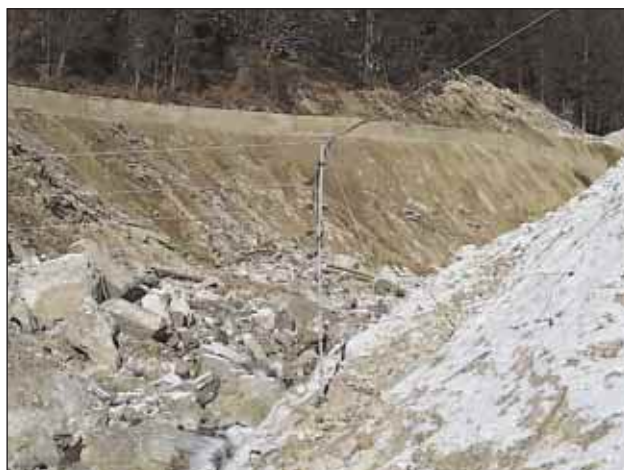
Slika 6. Tokovne zanke spodnje senzorske točke Figure 6. Current loops of the bottom line sensor
