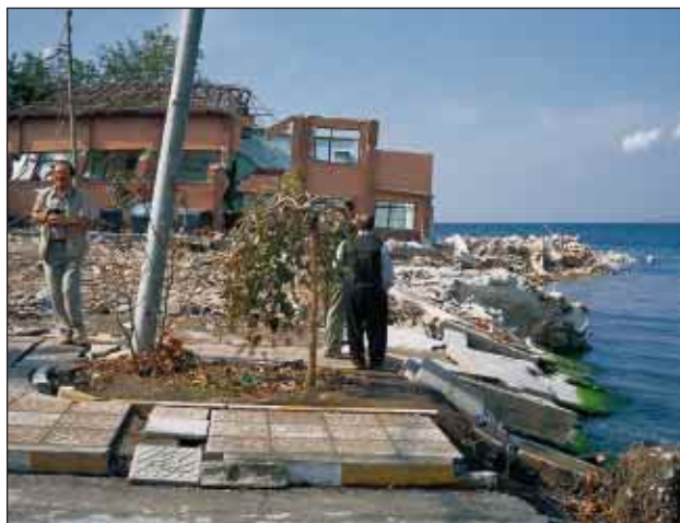
Slika 16. V mestu Degirmendere se je del obale v širini 50–60 m zapeljal za približno 150 m v morje, v globino 40 metrov. (foto: R. Vidrih) Figure 16. In the city of Degirmendere, a 50–60 m wide part of the coast slid approx. 150 m to a depth of 40 m. (photo: R. Vidrih)
