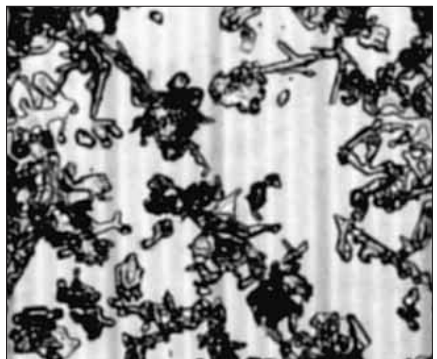
Slika 7. Polsteni sneg – prvotni kristali so še prepoznavni (razmik med navpičnimi črtami je 0,2 mm) Figure 7. Faceted snow – the original crystals are still recognizable (vertical interval 0.2 mm)
