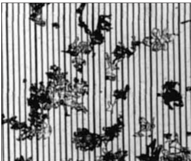
Slika 7. Polsteni sneg – prvotni kristali so še prepoznavni (razmik med navpičnimi črtami je 0,2 mm) Figure 7. Faceted snow – the original crystals are still recognizable (vertical interval 0.2 mm)
