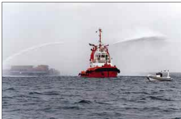
Slika 1. Ladijski vlačilec Mars z vodnimi topovi gasi požar na goreči ladji (foto: FPA Koper) Figure 1. MARS towboat employing water canons to extinguish a fire on a burning ship (photo: FPA Koper)
