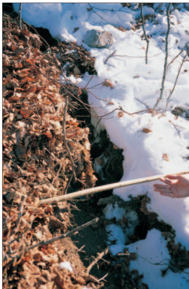
Slika 8. Domačini na izviren in preprost način merijo premike. (foto: M. Zorn)
