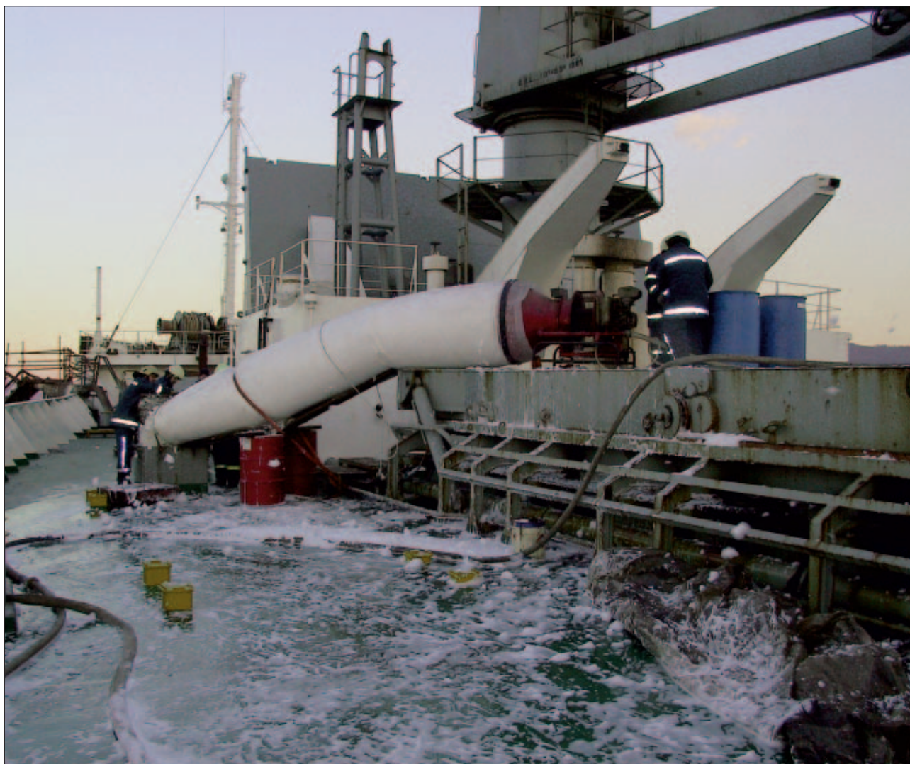
Slika 7. Dovajanje pene v skladišče št. 2 skozi vhodno odprtino (foto: A. Bubnič)
