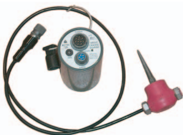
Slika 5. Enokanalni prenosni seizmograf RefTek Texan. Pri projektu Alp 2002 bo uporabljenih 1000 takšnih naprav, od tega 135 v Sloveniji.
