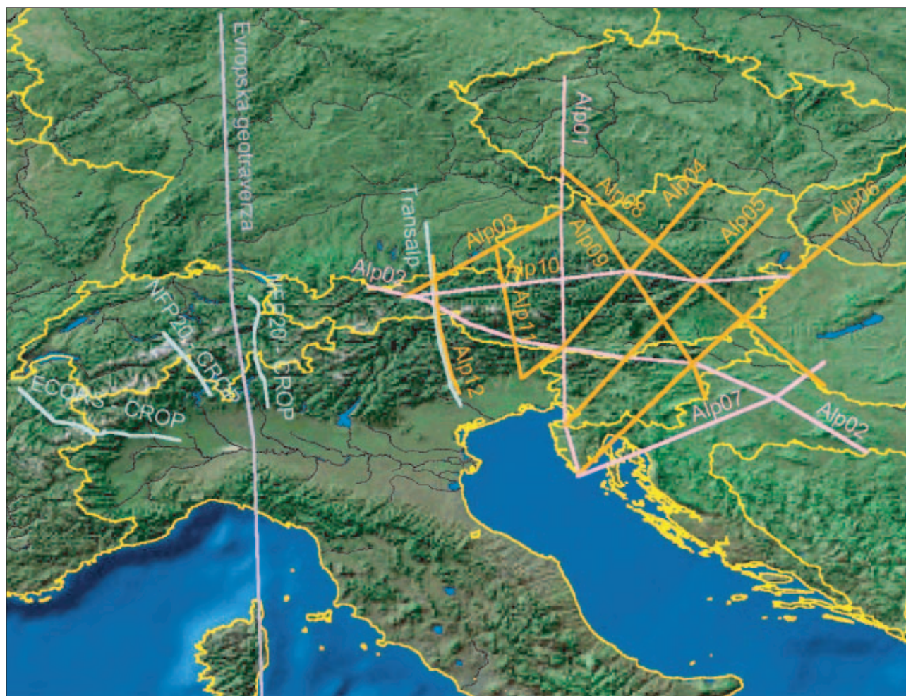
Slika 1. Položaj glavnih globokih seizmičnih profilov prek Zahodnih in Centralnih Alp (modro) in profilov, ki bodo izmerjeni v okviru projekta Alp 2002. Profili gostejših meritev so vijolični, redkejših meritev pa oranžni.
