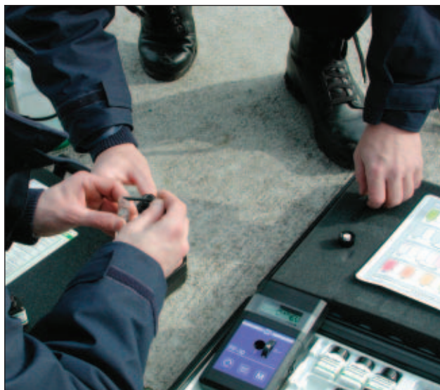
Slika 11. Dodajanje reagentov za fotometrično analizo vode – regijske enote (foto: B. Kuntarič)
