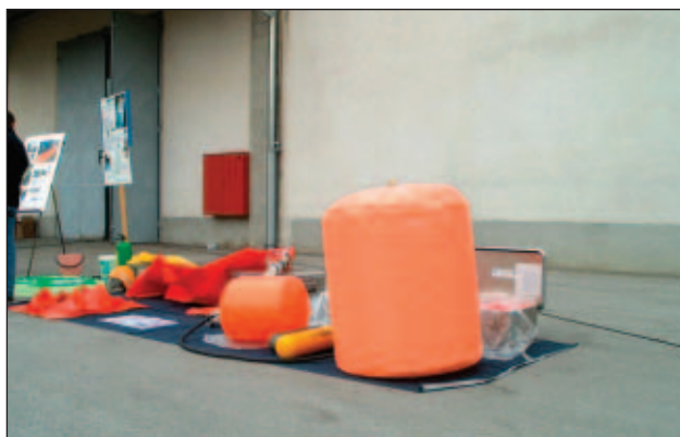
Slika 22. Komplet za zatesnitev iztekanja nevarnih snovi – državna enota (foto: Z. Čadež)
