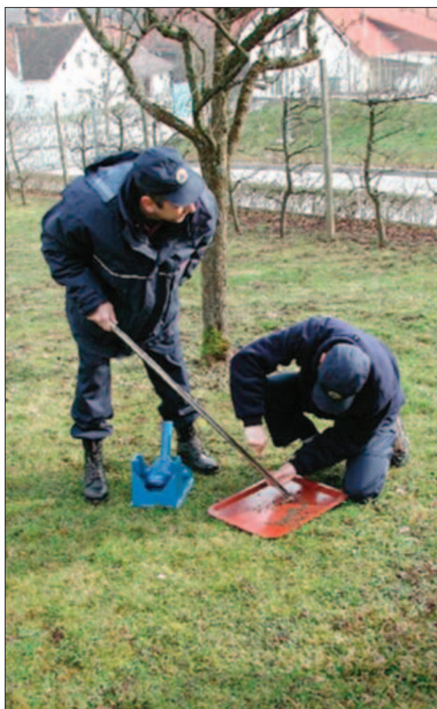
Slika 4. Odvzem vzorca onesnažene zemlje – regijske enote (foto: B. Kuntarič)
