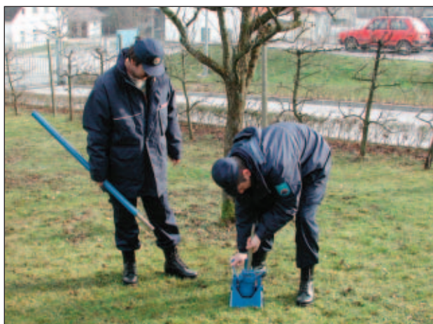
Slika 2. Izvlačenje sonde za ugotavljanje onesnaženosti zemlje s posebnim retraktorjem – regijske enote (foto: B. Kuntarič)
