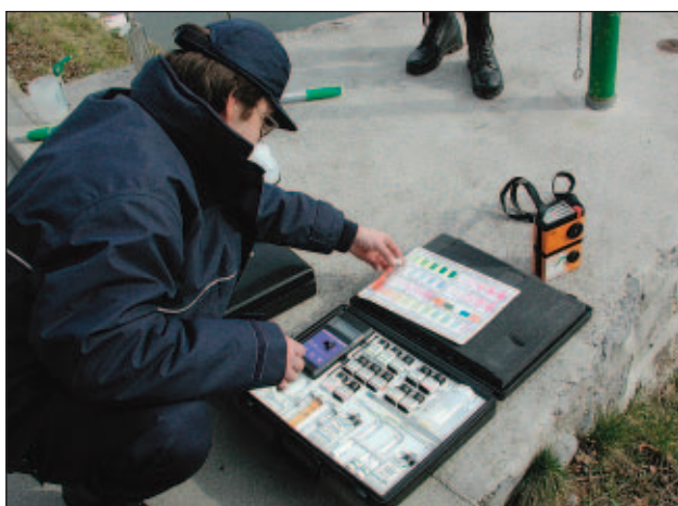
Slika 17. Kolorimetrična analiza vode – regijske enote (foto: B. Kuntarič)
