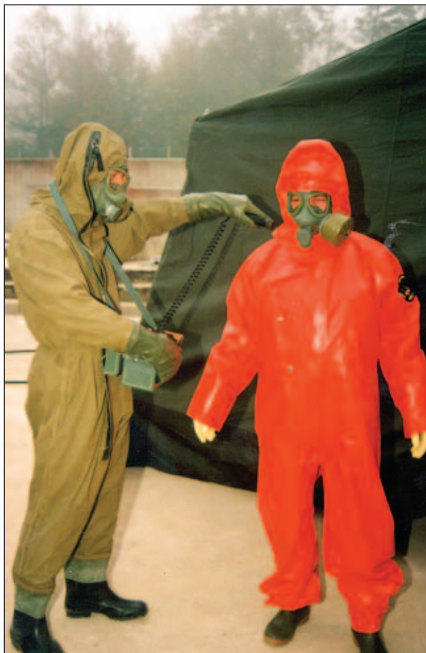
Slika 12. Ugotavljanje uspešnosti radiološke dekontaminacije – občinske enote (foto: Z. Čadež)
