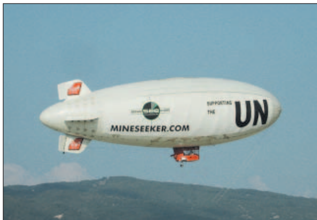
Slika 10. Zračna ladja »Mineseeker«, uporabljena za izvidovanje nevarnih območij (foto: S. Saunders)
