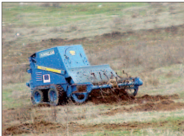
Slika 7. Slovaški stroj za deminiranje Božena je vodena na daljavo. (foto: M. Bizjak)
