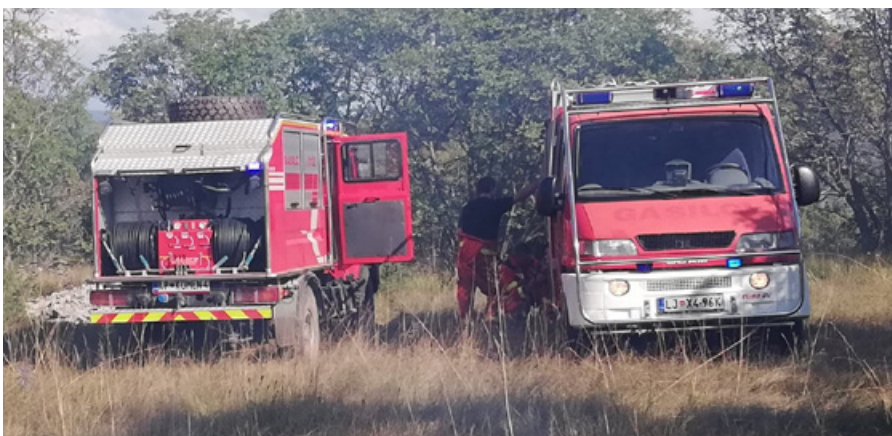
Slika 2: Srednje velika gasilska vozila GVGP-2 Bremach in Scam z več kot 1000-litrskimi rezervoarji in širino pod 230 centimetri (Foto: J. Saražin)
