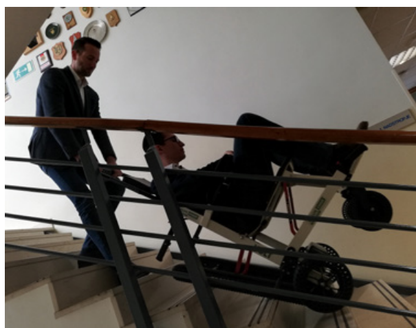
Slika 3: Evakuacijski stol za prevoz gibalno ovirane osebe po stopnicah navzdol in navzgor (foto: M. Gris)
