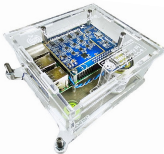
Slika 1: Seizmograf Raspberry Shake 4D
