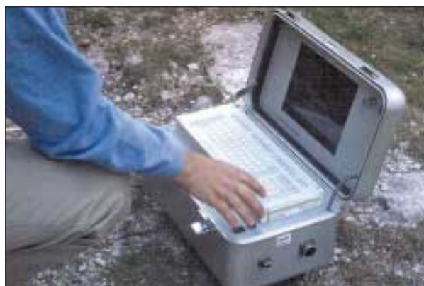
Slika 2. Seizmograf, uporabljen za meritve seizmičnega nemira Figure 2. Seismograph used for microtremor measurements.
