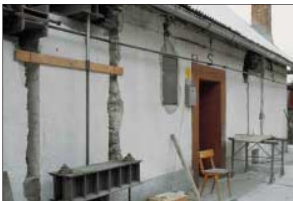
Slika 7. Zasnova preiskave tipičnega kamnitega zidu (foto: M. Tomažević)
