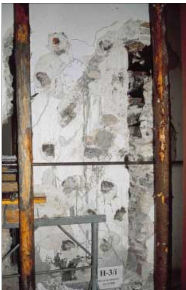
Slika 8. Razpoke v injektiranem kamnitem zidu pri doseženem mejnem stanju porušitve (foto: I. Klemenc)
