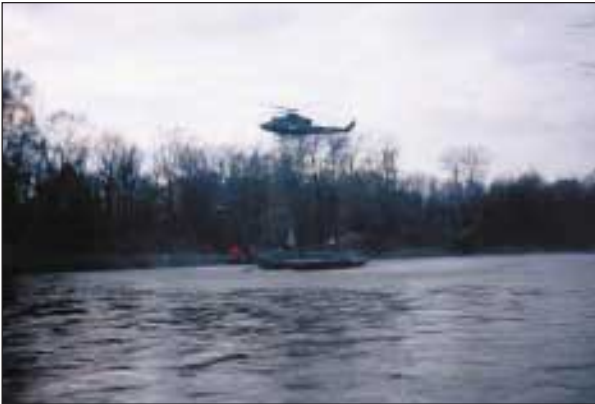
Slika 13. Posadka helikopterja 15. brigade vojaškega letalstva Slovenske vojske spušča montažni zbiralni bazen na brod (foto: S. Jauk)
