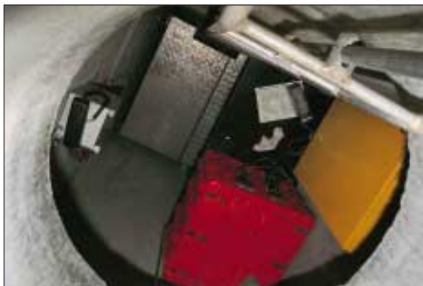
Slika 5. Jašek s seizmometri in zajemalnimi napravami potresne opazovalnice v gozdičku na robu Züricha (foto: P. Sinčič)
