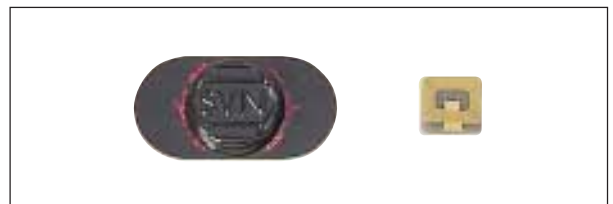
Slika 1. Elektronska tablica in čip: na desni je čip v originalni izvedbi, na levi pa je čip že vgrajen v plastično ohišje z lepilnim trakom na spodnji strani, pripravljen za pritrjevanje na gasilnik (foto: B. Drašler)
