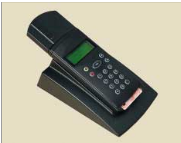
Slika 2. Ročni terminal z vmesnikom in vstavljeno profesionalno kartico / profesionalna kartica (foto: B. Drašler) Figure 2. Handheld terminal with docking station / smart card (photo: B. Drašler)
