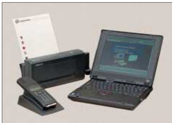
Slika 5. Prikaz sistema elektronskih tablic za nadzor. Prenos podatkov iz ročnega terminala v računalnik in obratno poteka prek vmesnika, ki je povezan s priključkom COM 1 (oz. COM 2) na PC-ju. (foto: B. Drašler)
