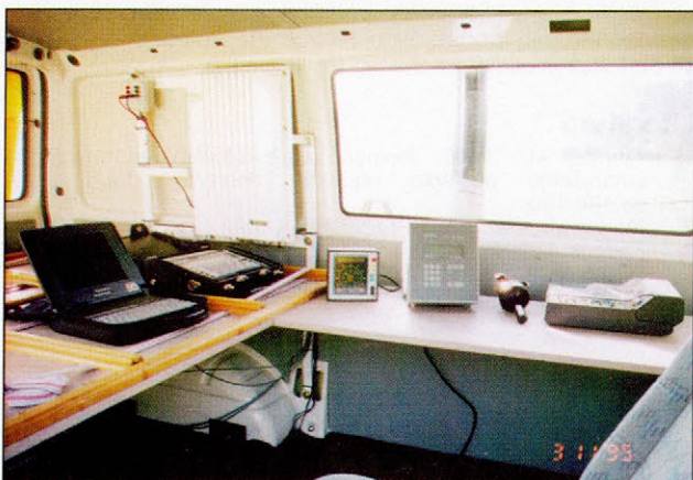
Slika 1. Notranjost mobilne enote z avtomatsko merilno postajo, anemometrom in računalnikom za pregled, arhiviranje in prenos merjenih podatkov (foto: S. Žlebir)
