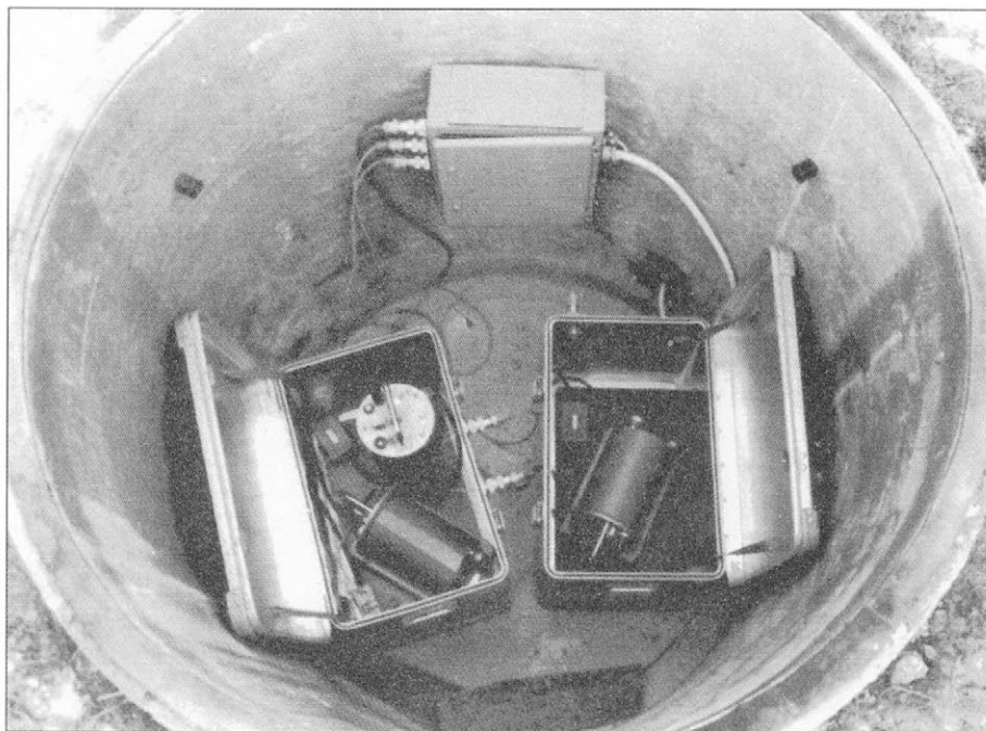
Slika 6. Trikomponentna opazovalnica ima v jašku tri seizmometre v dveh vodotesnih zabojih (potresna opazovalnica na Vojskem)
