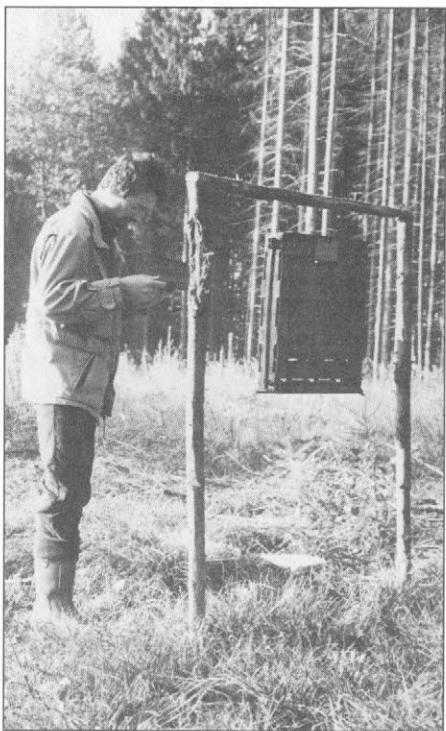
Slika 2. Kontrola ulova lubadarjev v ploščati režasti lovni pasti znamke Theysohn. Hrošče privablja v past feromonska vrečica, ki je obešena v notranjosti pasti. (Foto R. Pavlin).
