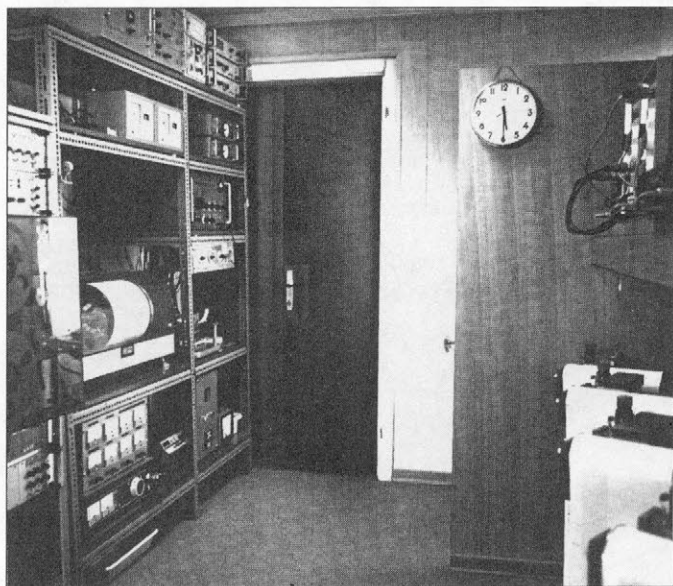
Slika 3. Merilni prostor na observatoriju na Golovcu. Na desni stojijo ojačevalniki in pisarji vidljivih zapisov seizmičnih nihanj. Na policah na levem delu slike so ure, sprejemnik časovnih signalov in usmerniki za napajanje z električno energijo. (Foto: arhiv seizmološkega zavoda).
