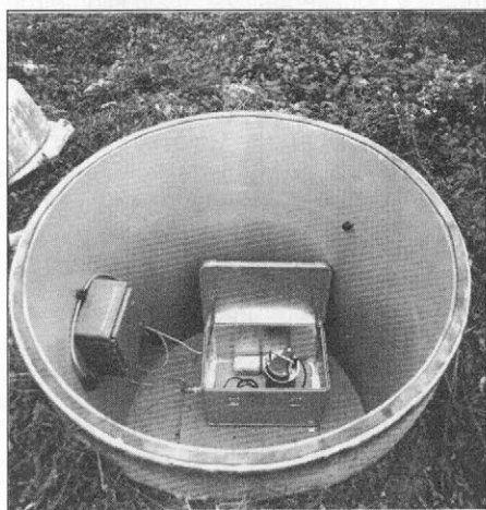
Slika 6. Vertikalni seizmometer seizmografa v Bojancih v Beli krajini stoji v betonskem jasku na trdni kaminski podlagi. (Foto: arhiv seizmološkega zavoda).
