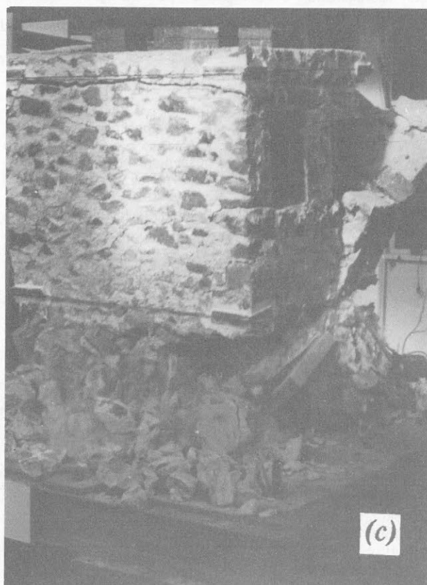
Slika 5. Tako so se med preiskavo na potresni mizi v laboratoriju ZRMK-ja v Ljubljani porušili modeli dvoetažnih kamnitih hiš: (a) model hiše z lesenimi stropi in nepovezanimi zidovi; (b) model hiše, kjer so lesene strope zamenjale polne armiranobetonske plošče; (c) model hiše z lesenimi stropi, ki je imela zidove povezane z jeklenimi vezmi; (d) podobno kot (c), le da je bil nad pritličjem opečni obok. (Foto: M. Tomaževič).
