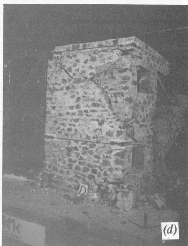
Slika 5. Tako so se med preiskavo na potresni mizi v laboratoriju ZRMK-ja v Ljubljani porušili modeli dvoetažnih kamnitih hiš: (a) model hiše z lesenimi stropi in nepovezanimi zidovi; (b) model hiše, kjer so lesene strope zamenjale polne armiranobetonske plošče; (c) model hiše z lesenimi stropi, ki je imela zidove povezane z jeklenimi vezmi; (d) podobno kot (c), le da je bil nad pritličjem opečni obok. (Foto: M. Tomaževič).
